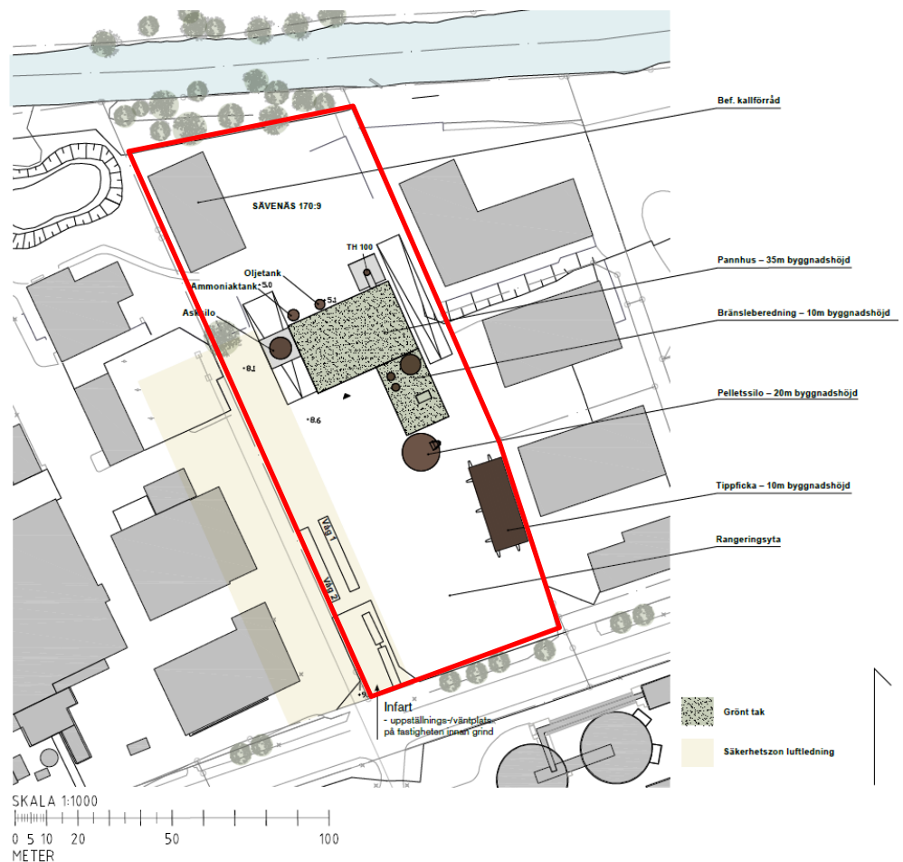
Figur 2. Exempellayout för bränslealternativet pellets, med plats för bränslemottagning, bränslesilos, bränsleberedning (malning av pellets till träpulver) och ny panna/pannor (Göteborg Energi, 2023).
